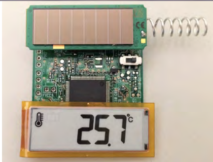
Prototyp des E-Paper-Displays für einen Temperatursensor
