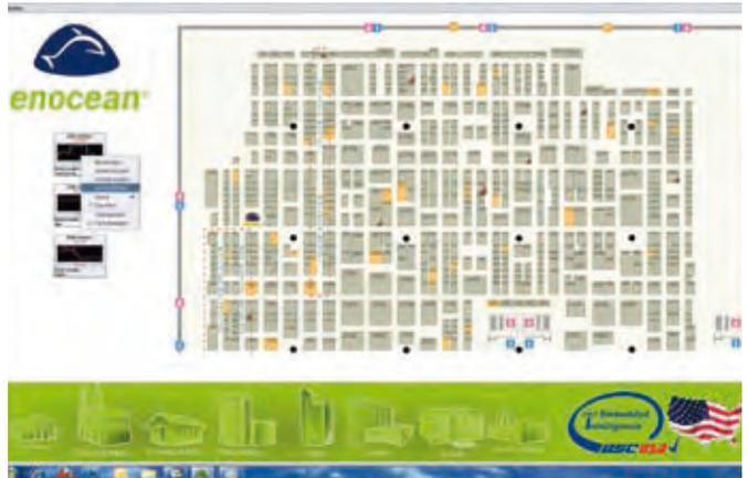
Strom-, Wasser- und Gasverbrauchs inklusive Zählerstand an verschiedensten Stellen innerhalb des Gebäudes. Mit der Software von BSC werden die aktuellen Stände der Stromzähler überwacht und mit den Vorgaben verglichen. Wenn die Waschmaschine beispielsweise angeschaltet werden soll, der aktuelle Energieverbrauch sich jedoch bereits an der Grenze zum höheren Stromtarif bewegt, kann das System mitteilen, dass es besser wäre, mit der Wäsche noch zu warten.
