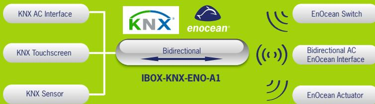
*Intesis hat ein bidirektionales KNX-EnOcean-Gateway entwickelt, mit dem sich Sensoren, Aktoren und bidirektionale EnOcean-Geräte nahtlos in KNX-Systeme einbinden lassen.*
