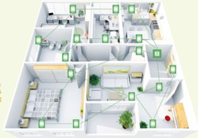
teten „Single Point of Failure“, also den Ausfall eines einzelnen Gerätes. Unabhängig von den baulichen Gegebenheiten funktioniert das ViNET Routing immer dann, wenn sich mindestens zwei damit ausgestattete EnOcean-Geräte innerhalb ihrer Funkreichweite befinden. Hören sich drei oder mehr ViNET-Geräte gegenseitig, werden alternative Routen aktiviert. Sensoren und Funkswitcher arbeiten selbstverständlich weiterhin so wie bisher. Ihre Signale werden über ViNET sicher zum Ziel geleitet.
