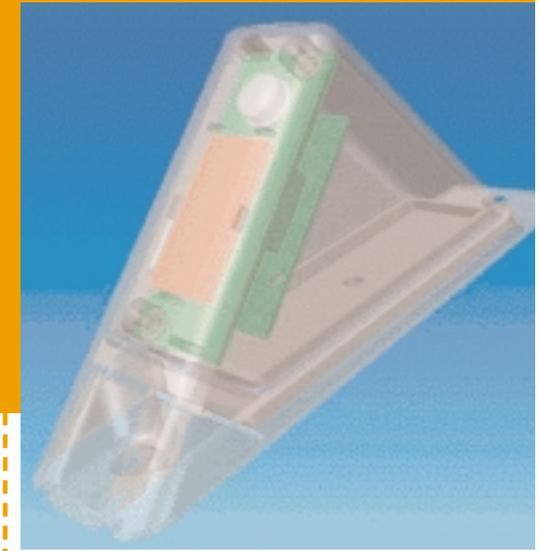
wicklung und Erweiterung des STM-Moduls um eine Platine, welche die Photodiode zur Erfassung der Helligkeit und die Solarzelle trägt, für die Mitarbeiter unserer Elektronikentwicklung ein Leichtes. Ebenso problemlos verlief die Integration des Empfangsmoduls in unsere Steuer- und Auswerteeinheit.
