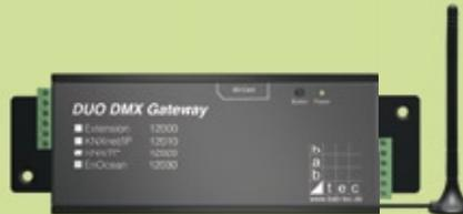
DMX-Ausgänge mit jeweils 512 Kanälen. Damit können beispielsweise zwei Räume über ein Gerät unterschiedlich angesteuert werden. Neben der Verknüpfung von Lichtszenen lassen sich auch die einzelnen Kanäle direkt mit
