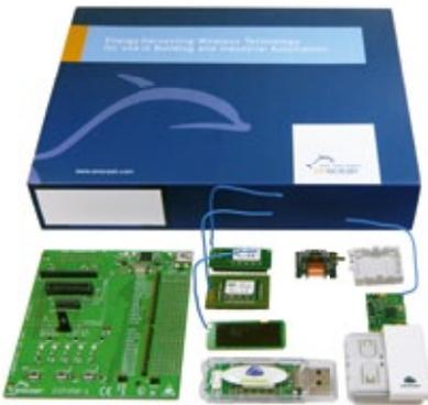
Das Developer-Kit EDK 350 umfasst die gesamte Produktpalette, von Energiewandlern über Funkmodule bis hin zu vorgefertigten Produktlösungen. Entwickler können mit dem Kit eine umfassende Anzahl batterieloser Funkanwendungen entwerfen, darunter zum Beispiel Schalter, Temperatursensoren,
