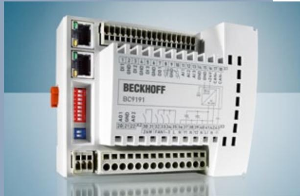
Kabel an den BC9191 angeschlossen. Die EnOcean-Daten werden somit direkt zum BC9191 übertragen und stehen der Applikation zur Verfügung. Das Kabel darf maximal 500 m lang sein. Im Produktportfolio der Beckhoff Automation GmbH ist ebenfalls eine KL6581-EnOcean-Masterklemme erhältlich, an die bis zu acht EnOcean-Module KL6583 angeschlossen werden können.
