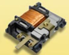
dadurch auch in kleine, flache Gehäuse mit kurzen Betätigungswegen. Mit der erzeugten Energiemenge von 120  $\mu$ Ws bei einer stabilisierten Spannung von 2 V kann jede Betätigung drei Funktelegramme betreiben. Auch die Rückbewegung liefert einen Energieimpuls. Bei maximal erlaubten Schaltwegen von 1,2 mm ermöglicht der Wandler mehr als 300000 Schaltzyklen, bei kleineren Schaltwegen sogar mehr als eine Million.
