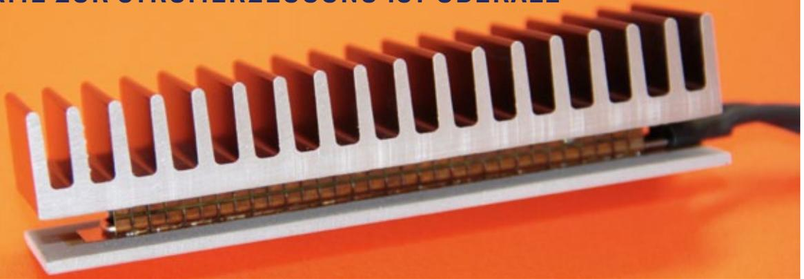
Die von O-Flexx Technologies entwickelten, einzigartigen, leichten und effizienten Thermoelektrik Generatoren (TEGs) eröffnen die Möglichkeit einer effektiven Energieversorgung für kabellose Sensoren und Aktoren. Dabei wird ein extrem reduzierter Systemaufbau zum „Abernten“ selbst großer Flächen realisiert.
