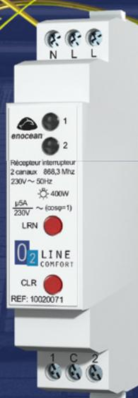
1-Kanal 5A DIN RAIL-Funkempfänger
