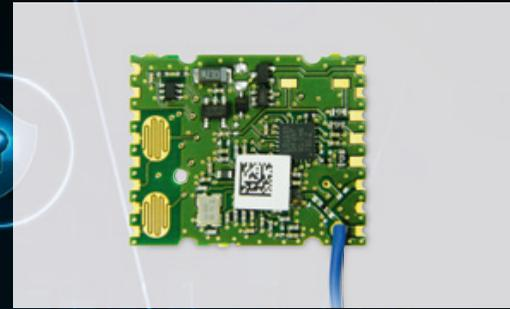
Mit dem neuen Funksensormodul PTM 535 entwickelt EnOcean die optimale Nutzung kinetischer Energie für batterielosen Funk konsequent weiter. Das miniaturisierte Modul hat eine erheblich höhere Reichweite und integriert erweiterte Sicherheitsmechanismen. In Kombination mit dem Energiewandler ECO 200 ermöglicht es individuell maßgeschneiderte Schalterlösungen für den Consumer-Markt, für Smart Homes und Industrie.
