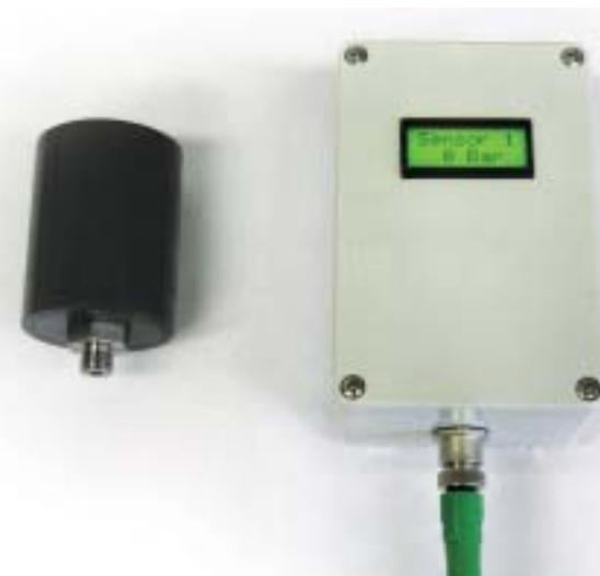
Drucksensor und Empfangsgerät
