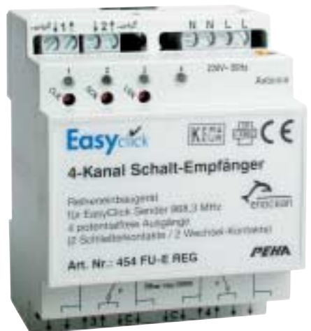
EasyClick-Reiheneinbau-Empfänger 454 FU-E REG 4-Kanal-Schaltmodul, Anschlussmöglichkeit: 2 Schließer und 2 Wechsler (potenzialfrei und abhängig voneinander programmierbar)
