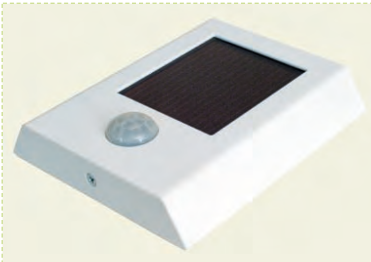
Omnio-PM-2008-01: Der 20 Millimeter flache Funk-Präsenzmelder „eagle PM101“ arbeitet vollkommen energieautark und meldet die Anwesenheit von Personen automatisch an Schaltaktoren oder Systeme zur Raumautomatisierung. Auf Wunsch kann die Präsenzerfassung auch in Abhängigkeit von einer voreinstellbaren Lichtschwelle erfolgen.
