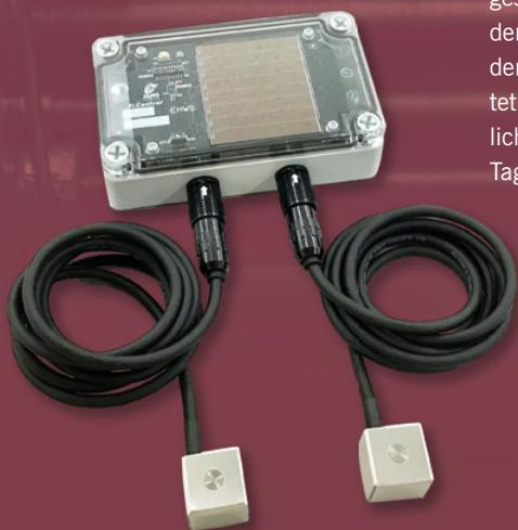
An dem Vibrationssensor lassen sich zwei Messfühler anschließen. Dies ermöglicht es, Vibration und Temperatur mit nur einem Gerät an zwei Stellen gleichzeitig zu erfassen.
