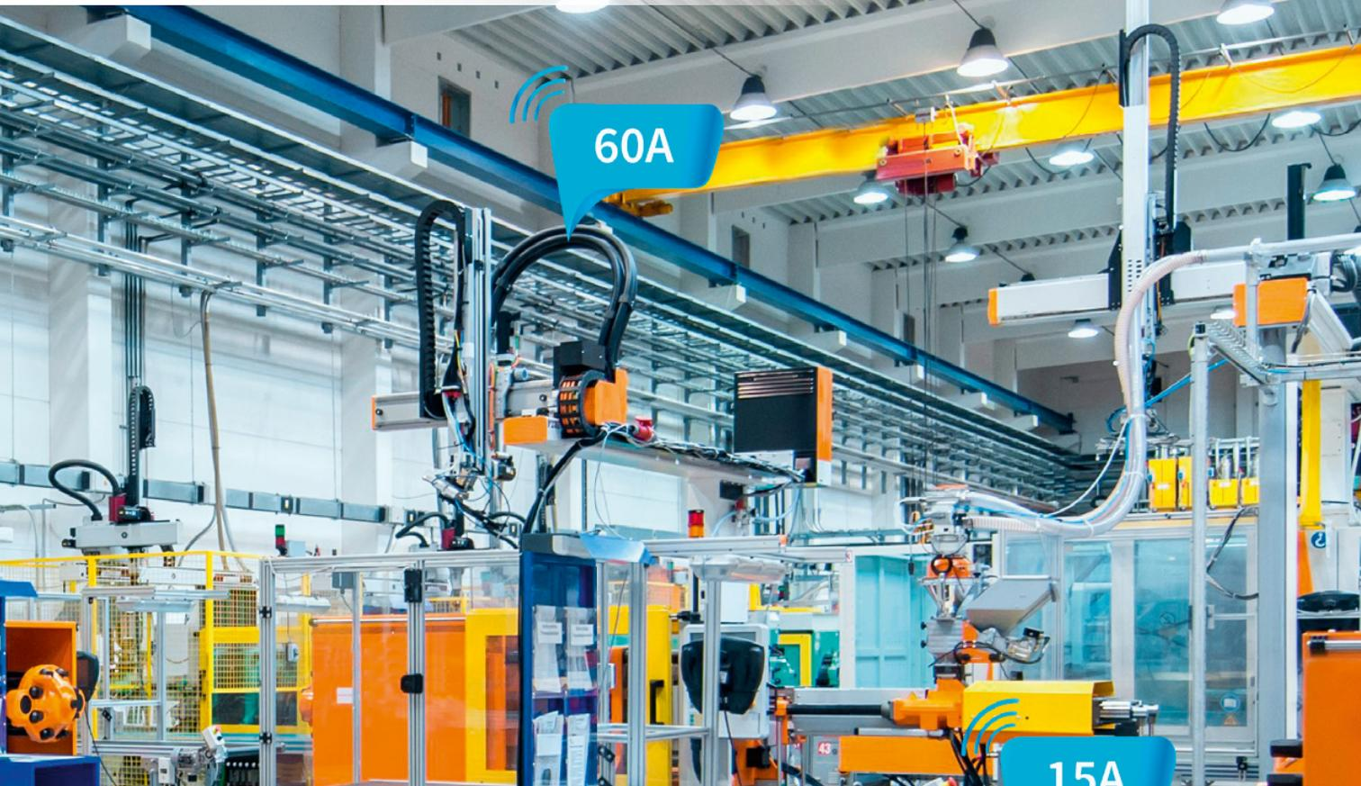
Die funkbasierten Stromsensoren (CT) messen alle 30 Sekunden den Wechselstrom (A) auf Maschinenebene. Die energieautarken Geräte nutzen die Energy Harvesting-Technologie von EnOcean und sind dadurch einfach zu installieren und nahezu wartungsfrei.
