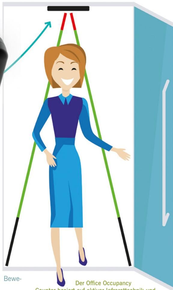
Der Office Occupancy Counter basiert auf aktiver Infrarottechnik und wird oberhalb der Tür angebracht.
